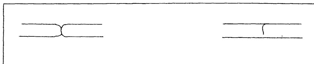
شکل ۲-۲۲: تصویر شماتیک چین خوردگی (الف) و سرد جوشی (ب) [۱].
